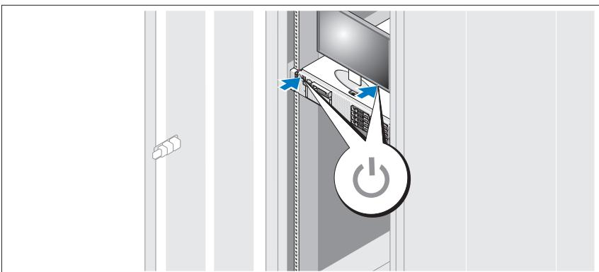
システムと、オプションのモニタ（使用している場合）の電源ボタンを押します。電源インジケータが点灯します。
