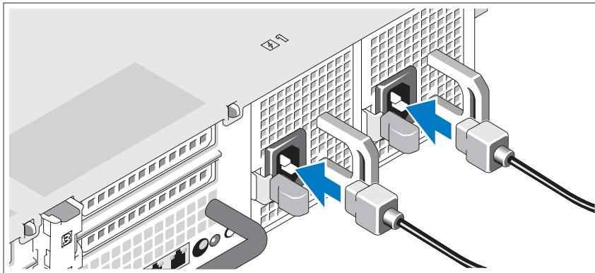
Sambungkan kabel daya sistem ke sistem dan jika monitor digunakan, sambungkan kabel daya monitor ke monitor.
