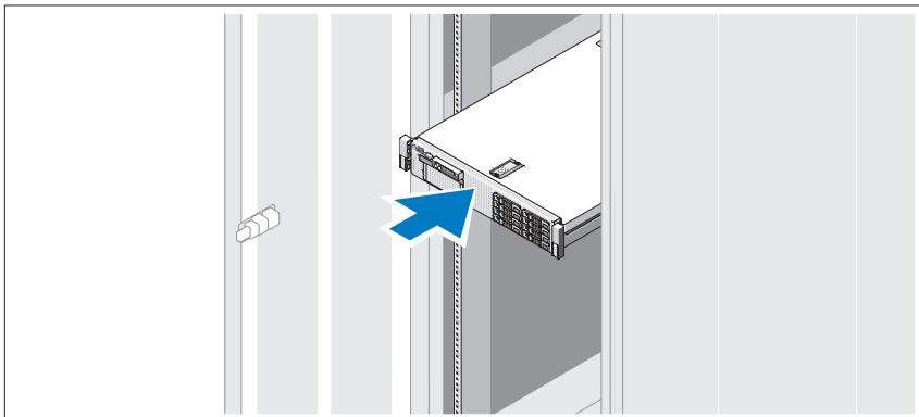
Susun rel dan pasang sistem di rak sesuai instruksi keselamatan dan instruksi pemasangan rak yang disediakan dengan sistem Anda.
