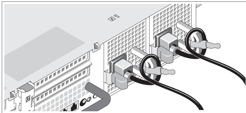
Tekuk kabel daya sistem dan masukkan ke dalam loop seperti yang ditunjukkan pada gambar dan kencangkan kabel ke braket menggunakan ikatan yang telah disediakan.
