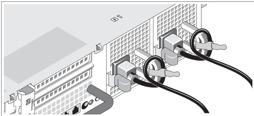
システムの電源ケーブルをループ状に曲げ（図を参照）、付属のストラップでプラケットに固定します。
